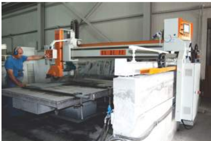
Ultima arrivata, macchina innovativa semiautomatica per il taglio della pietra lavica (Fabbricata dalla ditta COMEP di Giarre)
